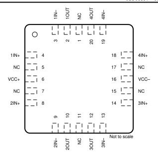
Figure 5-9. TL074 FK Package, 20-Pin LCCC (Top View)
